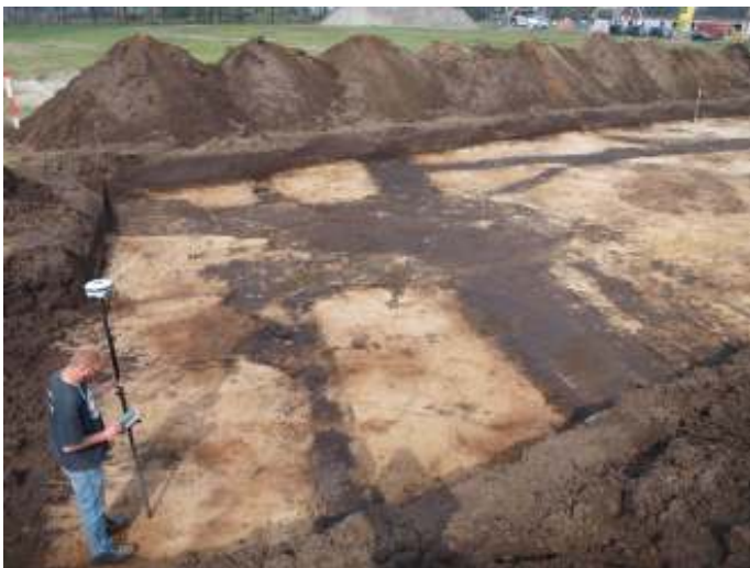
Geen meetlint, potlood en papier op een tafeltje meer, maar direct gps-gestuurd in de computer vastgelegd.
