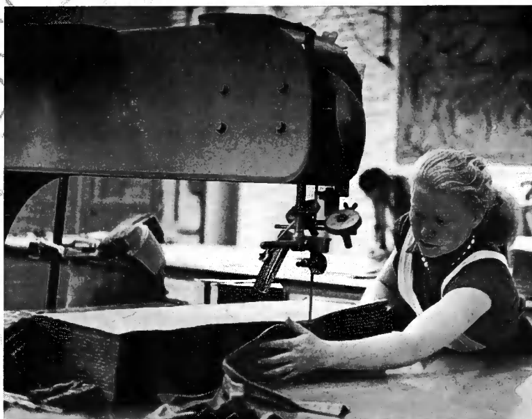
Afb. 193 Juffrouw Truus van Riet bediende hier met vaardige hand een gevaarlijke en vlijmscherpe lintsniijmachine. Als men de lijnen van de vereiste coupe goed in de gaten hield kon men achttien lagen stof tegelijkertijd snijden. Een knappe prestatie van deze dame in opperste concentratie.
