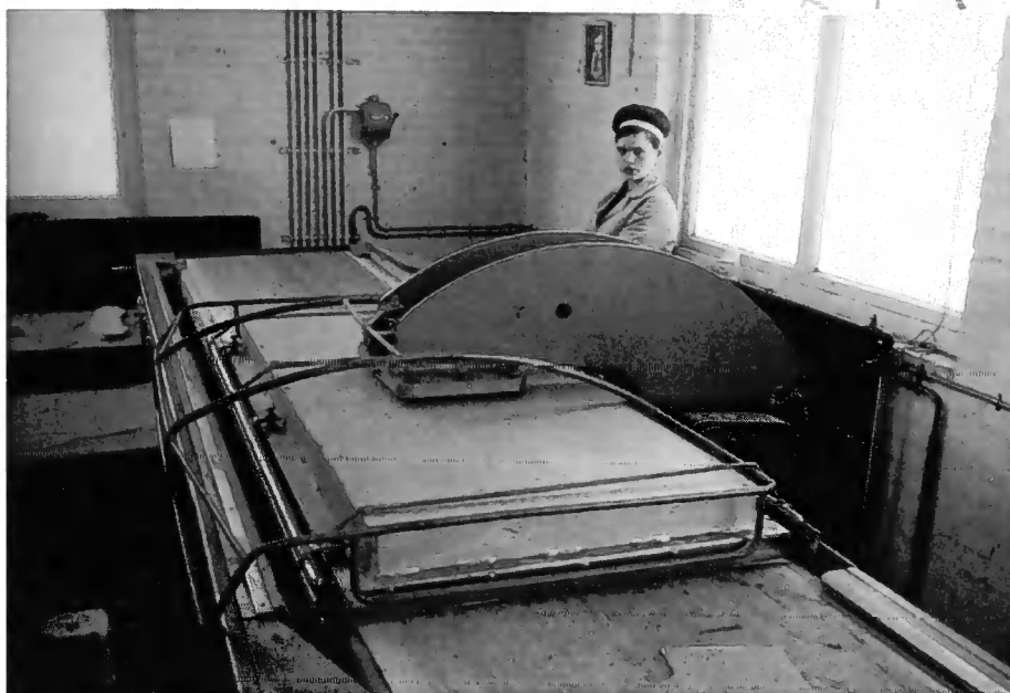
Afb. 199 Hier worden de panden en grotere onderdelen met vlieseline verwarmd waardoor de vlieseline plakt.
