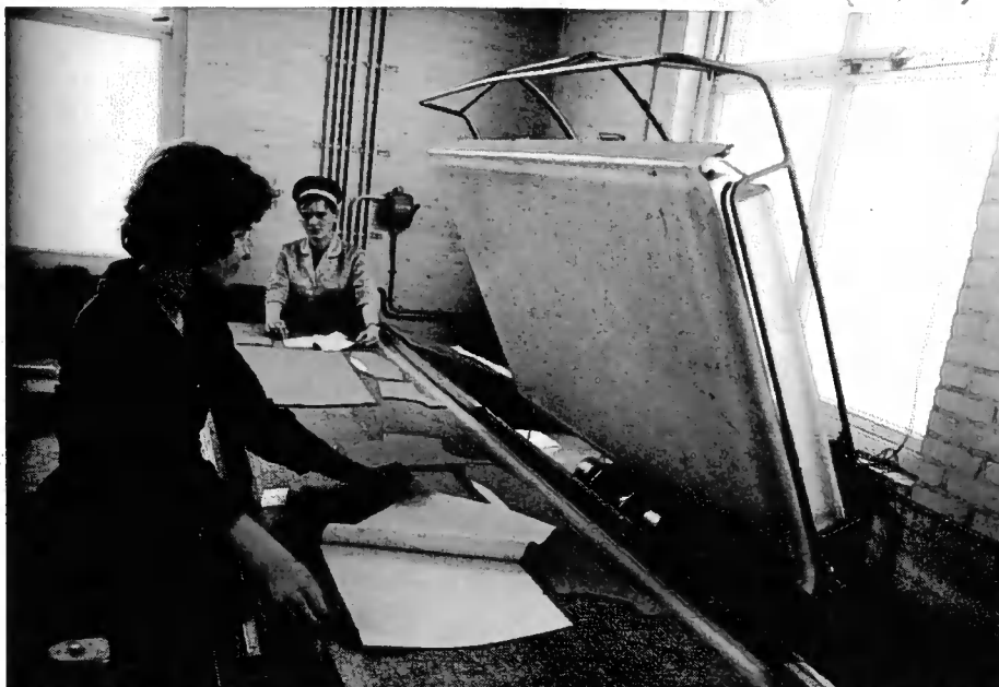
Afb. 198 Op de grote panden werd de vlieseline geplakt met de grote plakmachine.
