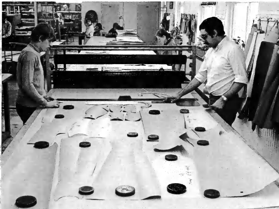
Afb. 177 Op de snijzaal zien we links Hans van der Westerlo en rechts Albert van Eijk met het opleggen van de patronen. Daarna werd het hele pakket stof met een vlijmscherp lintsnijmes gesneden.
