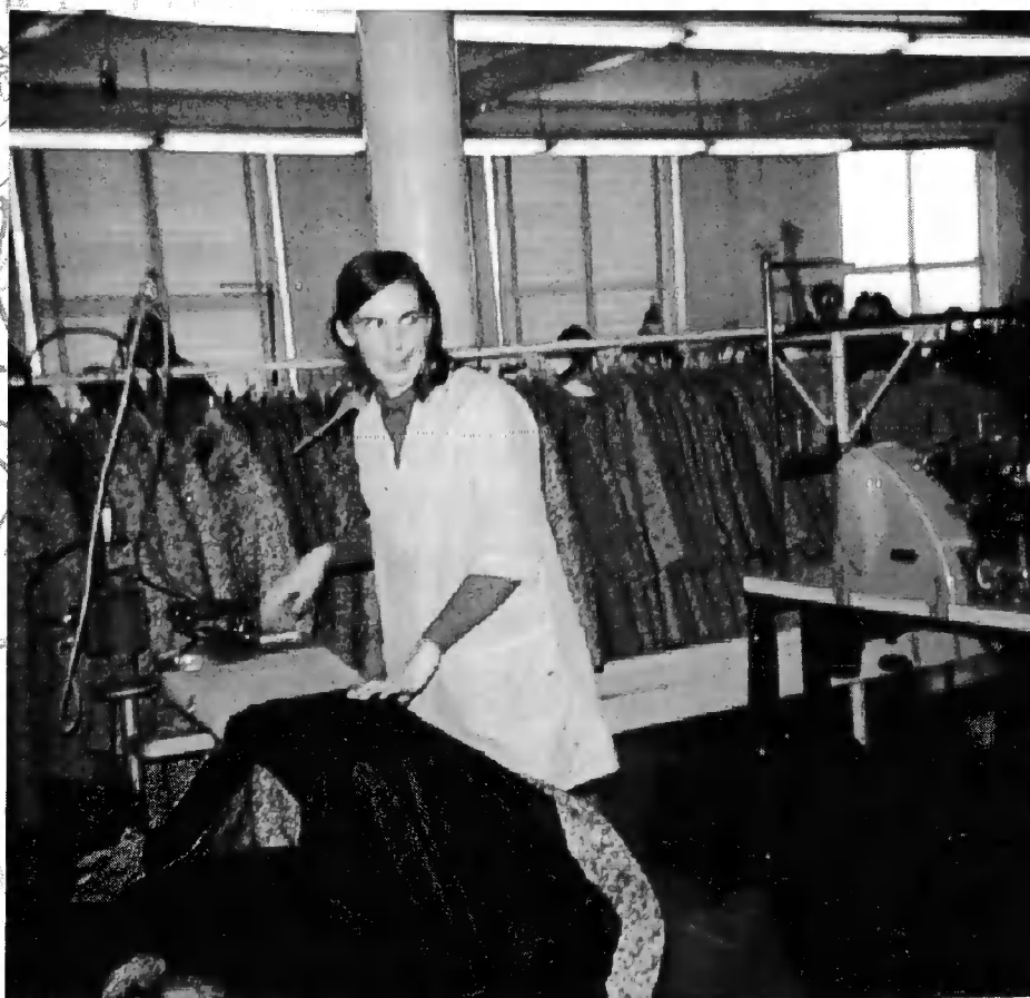
Afb. 178 Na vervaardiging van de mantels werd ieder product apart beoordeeld op kwaliteit en gecontroleerd op vlekken, losse draden, valse vouwen en andere eventuele onvolkomenheden. Zonodig werd er met een strijkijzer nog even de laatste plooitjes weggestreken. Deze onbekende 'strijkster' had de fotograaf al gezien.
