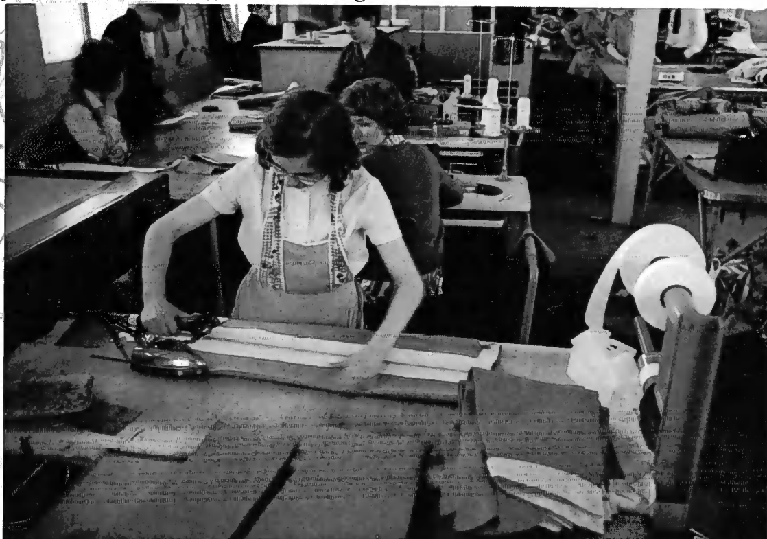
Afb. 197 Voor het in elkaar zetten van een mantel werd op de losse patroondelen eerst vlieseline geplakt om de mantel meer stevigheid te geven. De dame op deze foto doet dit werk met grote nauwkeurigheid.
